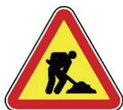
A23—Trabalhos na via
