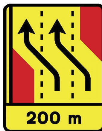
ST4—Desvio de via de trânsito
