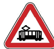
A28—Interseção com via onde circulam veículos sobre carris
