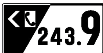
01b—Demarcação hectométrica da via — IC
