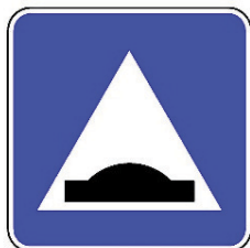
H48—Lomba redutora de velocidade
